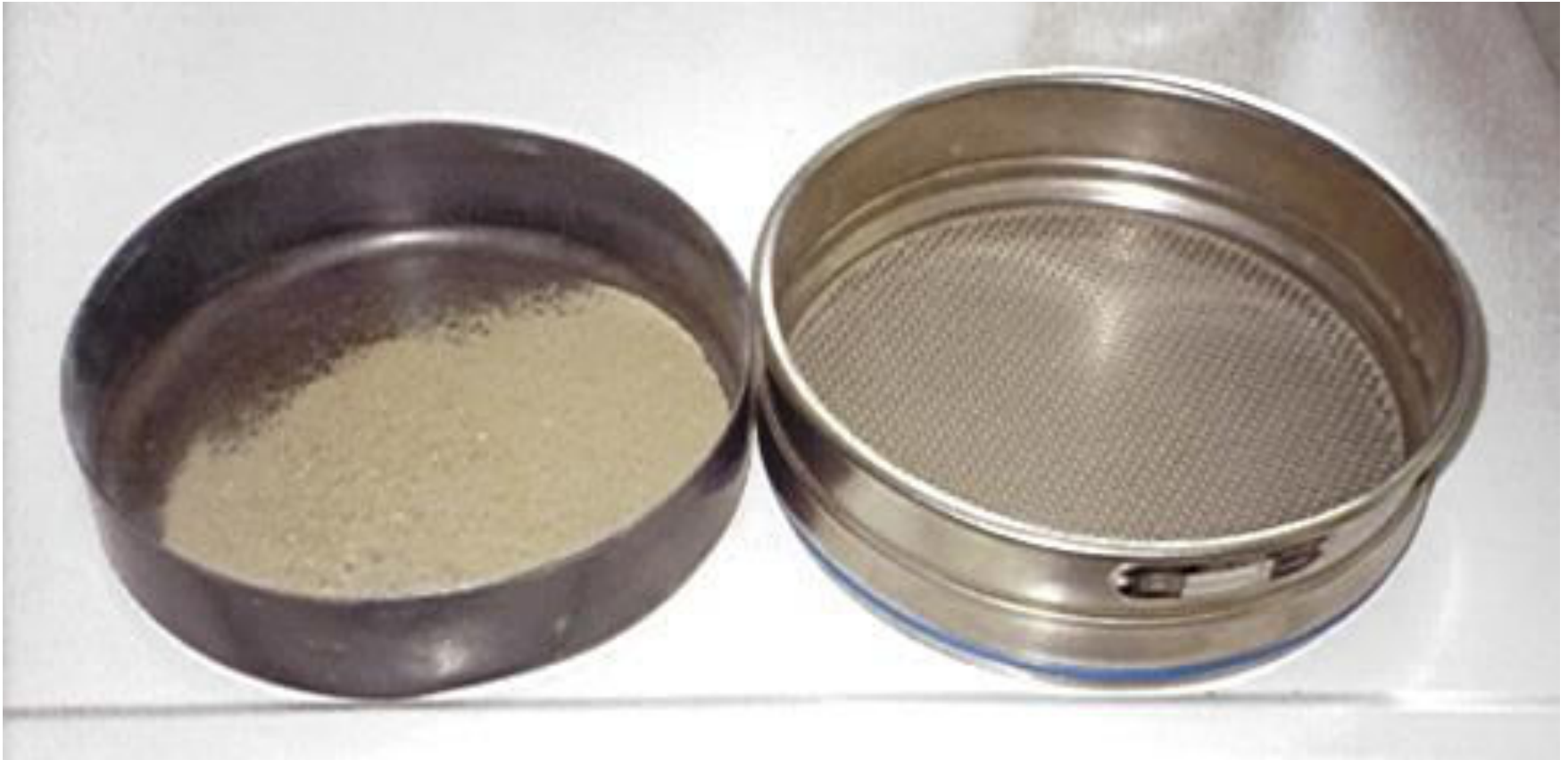
Abb. Prüfsieb nach DIN 4108 mit 2mm Siebdurchmesser
