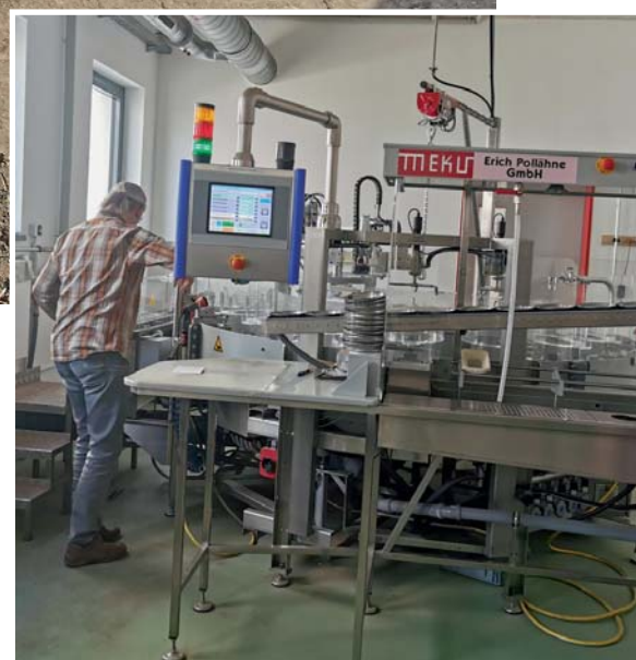
Aufbereitungsanlage zur Prüfung von Pflanzkartoffeln in der Prüfstelle
